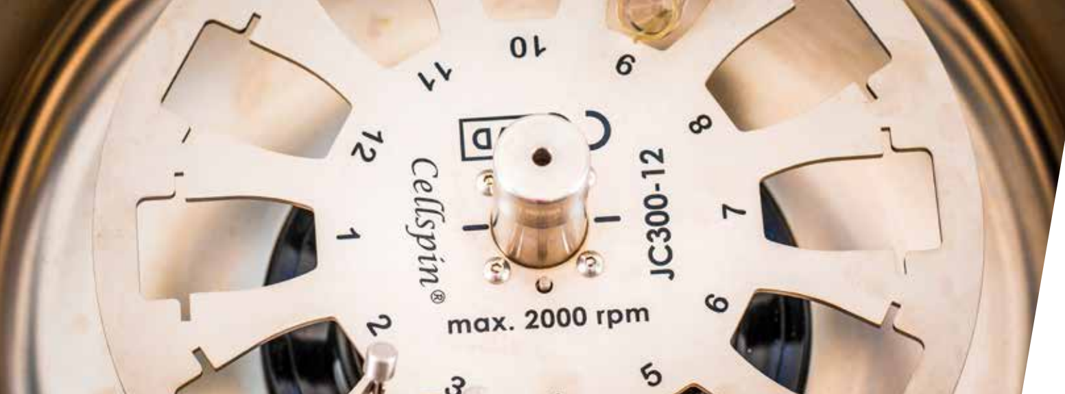
CS Rotor mit 12 Ladepositionen
