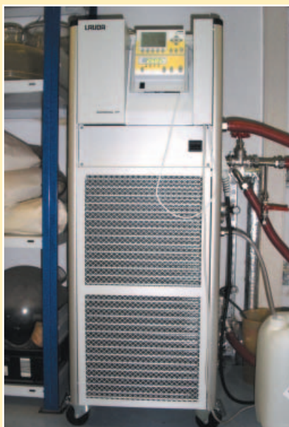
Platzsparende Anbindung des externen Verbrauchers an Integral XT
