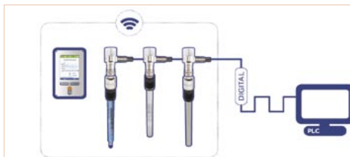
High-End-Anwendung ARC-Vision: Die Sensoren sind über Bustechnologie angebunden, das Bediengerät kommuniziert wireless.
